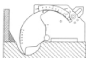
①アンダーカット深度測定 (0~25mm)
